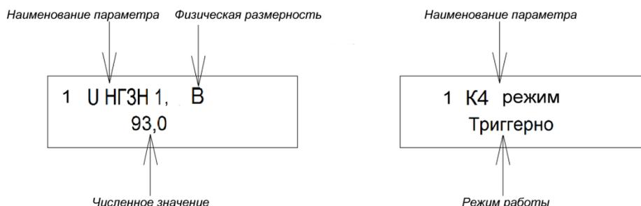
Рисунок 7 – Индикация значений текущих параметров
